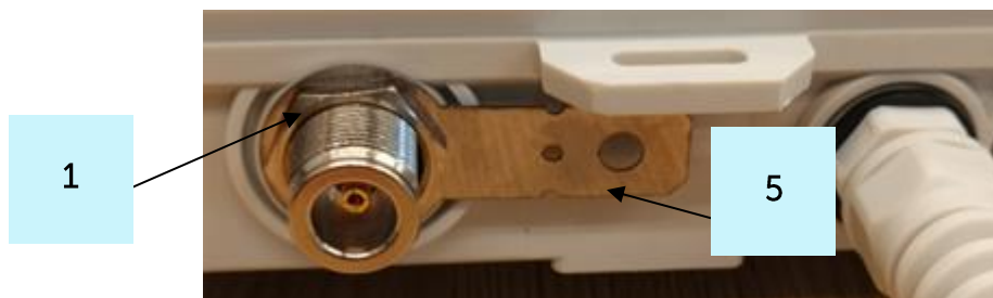
5 – контакт подключения заземления
